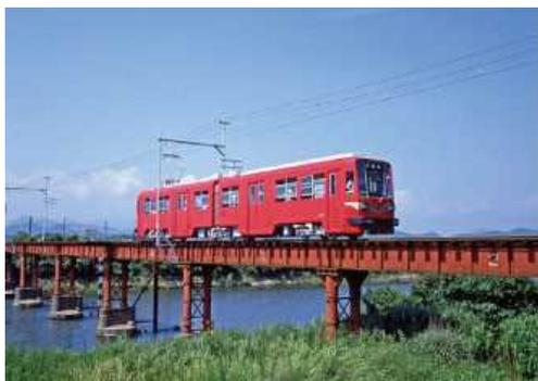
た、複電圧の高性能連接車、5編成10両製造 名鉄の軌道線車両で初の空気バネ台車・カルダン駆動。
